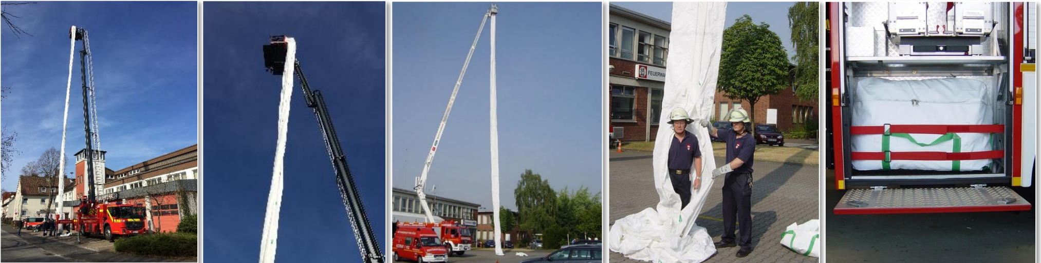
Mobiler Personenrettungsschlauch für Höhenrettungsfahrzeuge – beschleunigte Höhenrettung
